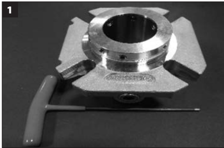
1 Outils nécessaires pour le démontage de la garniture mécanique : Clé hexagonale ( fournie avec la garniture mécanique ) ; une pincette et une pointe incurvée ( fournies par le client ; pour la dépose des joints toriques et du tube d'entraînement ).
