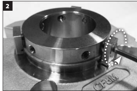
2 Déposez les clips de centrage et mettez-les au rebut.
