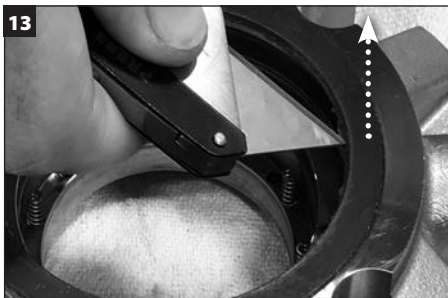
Déposez le joint d'étanchéité de la face d'appui du presse-étoupe du chapeau et mettez-le au rebut.
