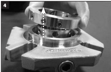
4 Déposez la bague de verrouillage de la chemise et mettez-la de côté.
