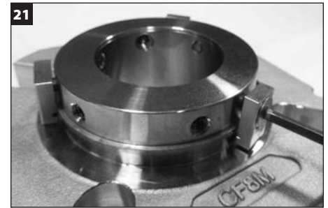
Installez les clips de centrage sur le diamètre externe de la bague de verrouillage avec les vis à tête plate du clip de centrage.
