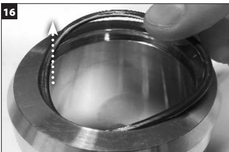
Déposez le joint torique de l'arbre (V) de la chemise et mettez-le au rebut.
